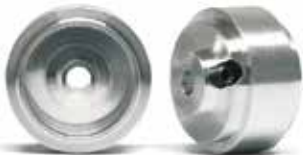
W14308015A ex PA33-Als Al Ø14.3 x 8 x 1.5mm wheels , M2 grub - 1.2g (2x)
