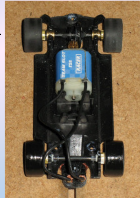
Der Escort II von Team Slot mit kräftigem Motor benötigt Blei hinter dem Leitkiel.
