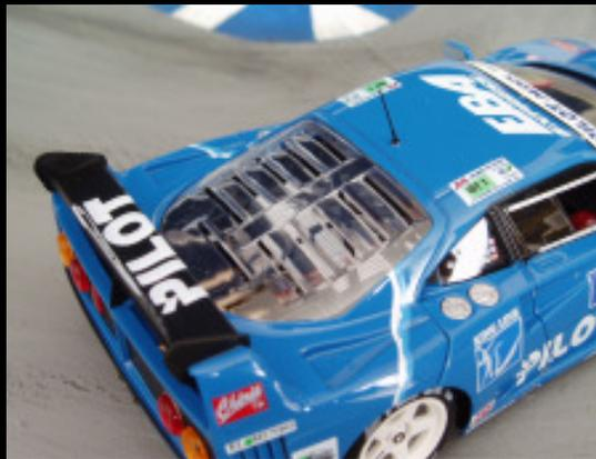
**Der Zwölfzylinder arbeitet unter einer Kunststoffglashaube mit Lüftungsschlitzen**
