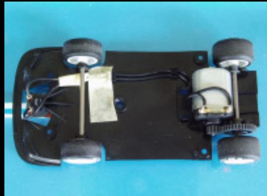
**Läuft bleifrei auf der Heimbahn: Das F40 Chassis ist für diesen Einsatz ausgewogen gebaut. Wir haben lediglich die Kabel mit einem selbst gewickelten Klebebandröllchen unter der Vorderachse durchgeführt. Platz für Blei ist genügend vorhanden, falls jemand trimmen möchte oder muss.**
