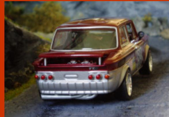
***Brüllendes Querrohr mit Fächerkrümmer am Heck. Der luftgekühlte Vierzylinder arbeitet unter der offenen Haube.***
