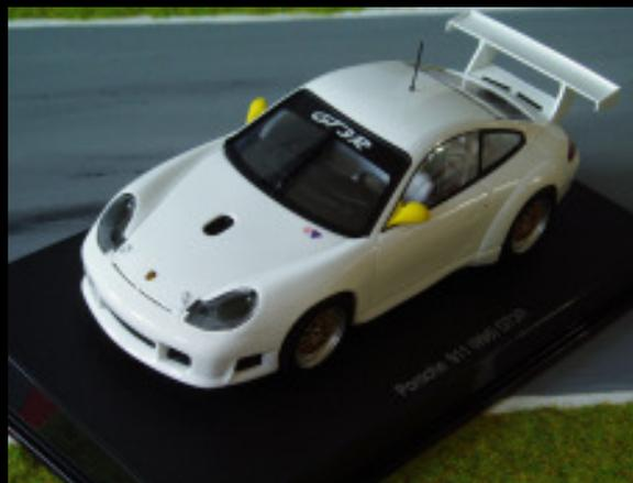
Baut man den Wagen ohne Magnet auf und beherzt ein paar Kniffe, fährt er ausgezeichnet auf der Heimbahn. Die Federung der Vorderachse muss weg! Sie stört den Vortrieb, die Feder der Leitkielrückstellung muss ebenso raus. Vorderreifen lacken, Hinterreifen leicht anschleifen und schon geht's mit voller Power über den Kurs. Leuchtende Augen gibt es nicht nur beim Piloten. Der GT3R ist rundum illuminiert. Das Rennsport-
