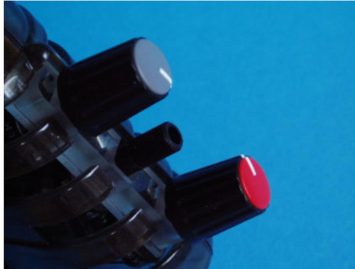
**Vollgasregler (kleines Rädchen mittig), umrahmt von verstellbaren Drehpotis für Gas und Bremse. Im Griff: Zwei Mini-Schalter:**
