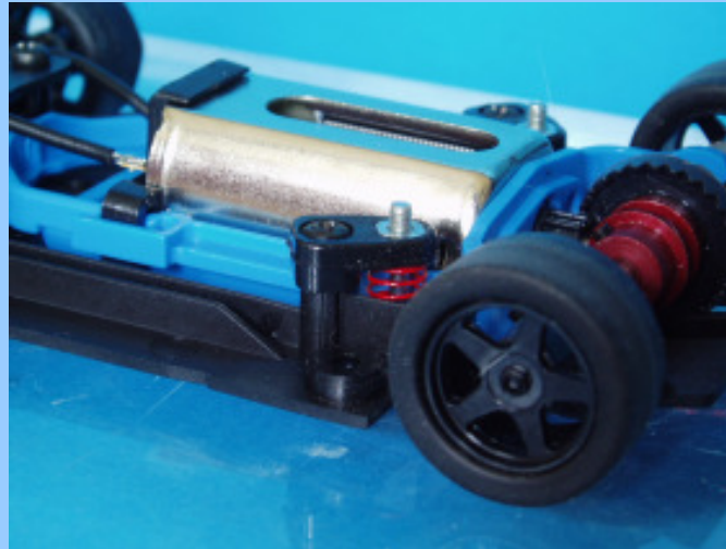
Pendelnd gelagerter Motorträger, der über Schrauben und Federn eingestellt werden kann. Beim Drehen von zwei Schrauben in der Bodenplatte kann die Hinterbauhöhe und die Vorspannung variiert werden. Die Vorderachse kann man über Madenschrauben von oben und unten perfekt abstimmen. Der Motor kann zur Fixierung verschraubt werden. Das Achszahnrad ist es bereits.
