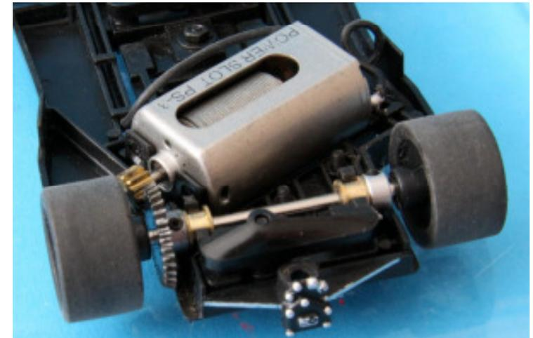
Anglewinder mit sehr beeindruckender Leistung, präzisen Achsen in Messinglagern plus Achstellring. Der Motorhalter ist variabel einstellbar und lässt sich entkoppeln.
