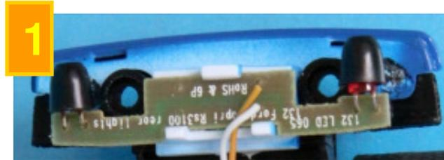
1. Heckschürze am Chassisende demontieren. Vorsichtig mit einem Schraubendreher abhebeln. LED-Einheit per Steckverbinder lösen.
