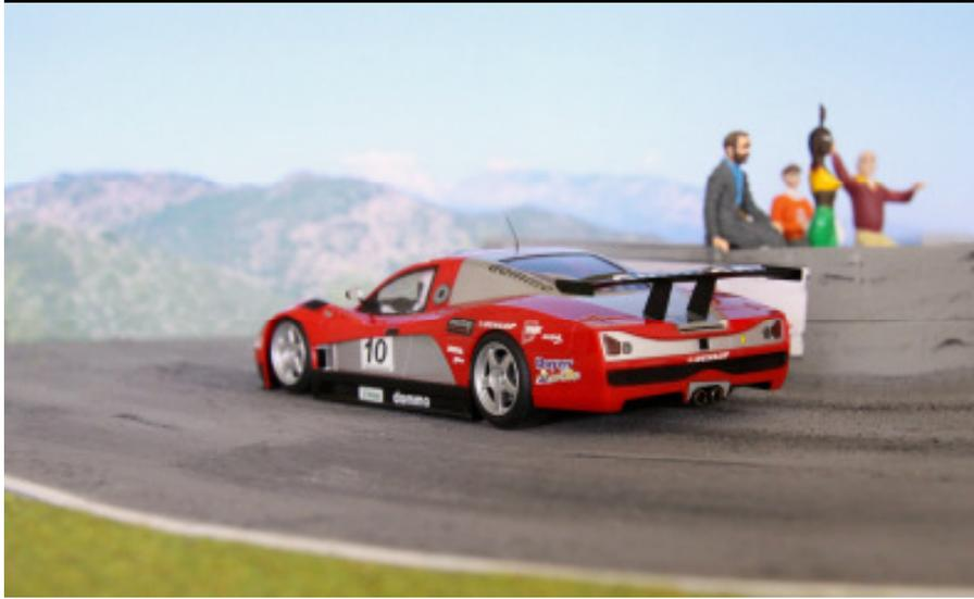
**Langer Radstand, Starrachse vorne, Reifen mit gutem Grip und perfekt gebrochenen Kanten. Im SR10 ist Platz zur individuellen Setup-Findung mit Blei: Wir haben Pb in den Seitenkästen! Den Frontspoiler haben wir abgetrennt und an der Karo verklebt. Das Chassis rundum 1mm verjüngt. Entkoppelt läuft der SR21 besser, leiser und schneller mit 12 Voltan Saft.**
