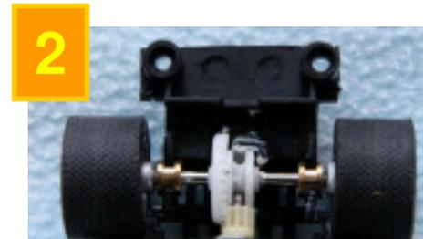
2. Chassis-Heck um die beiden Karohalter per Trennscheibe schrittweise abtragen. Die hinteren Steher der Karo um 1 mm kürzen. So kann das Capri-heck tiefer und kann entkoppelt arbeiten.
