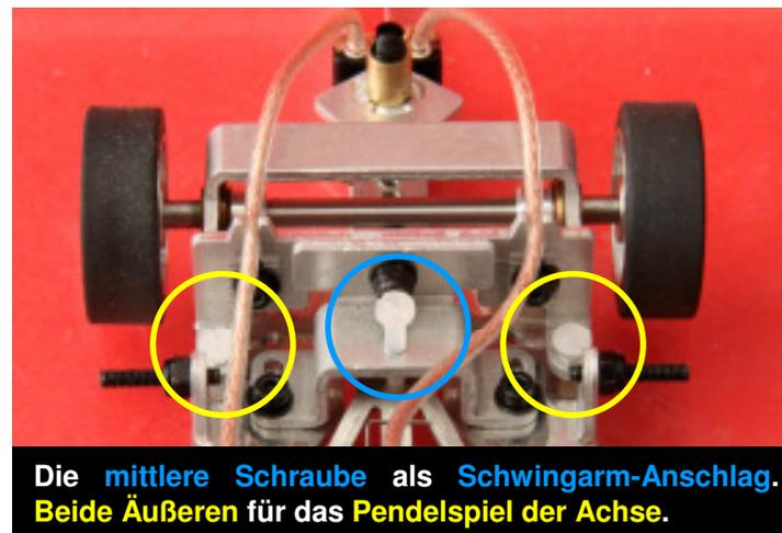
Die **mittlere Schraube** als **Schwingarm-Anschlag**. **Beide Äußeren** für das **Pendelspiel der Achse**.
