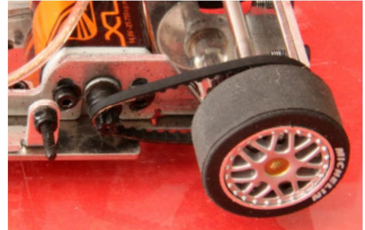
Zahnriemen? Warum nicht. Funktioniert auch an Harley und Buell. Über die Spannung stellt man das Losbrechmoment von Motor und Bremse ein. Saubere Zündkabelführung zum Schwenkarm des Leitkiels über die pendelnd gelagerte Vorderachse.
