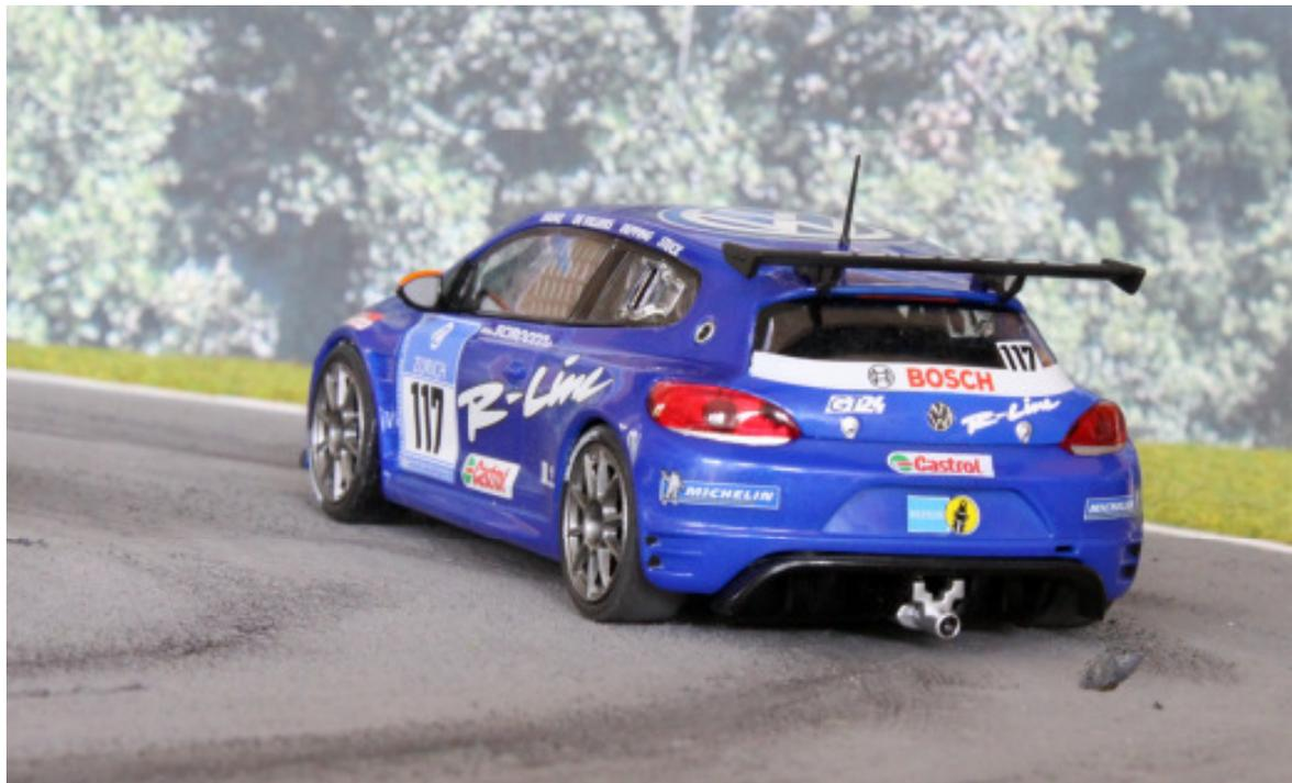
Durch seine breite und flache Bauweise liegt der VW satt auf der Piste. Sogar der Auspuff wandert so schwerpunkttief wie möglich. Identische Bereifung vorne und hinten, wie es in der Zweitliterklasse üblich ist. Der Heckflügel kann abgenommen oder fixiert werden. Das aerodynamische Bauteil integriert sich ins Heck und hält, wenn man auf der Strecke bleibt.
