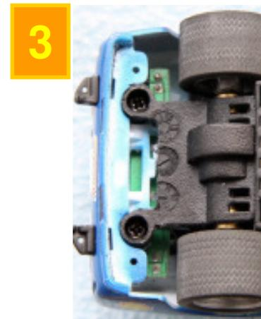
3. Heckschürze samt LED-Einheit an Karo verkleben. Das bearbeitete Chassisheck fügt sich darin ein. Überstehendes Material unten am Fahrerinlet plan schleifen, damit nichts klemmt. Fertig!
