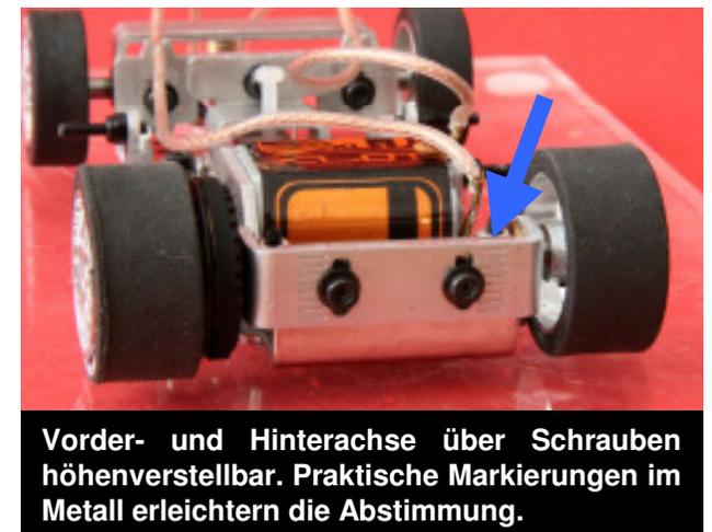
Vorder- und Hinterachse über Schrauben höhenverstellbar. Praktische Markierungen im Metall erleichtern die Abstimmung.
