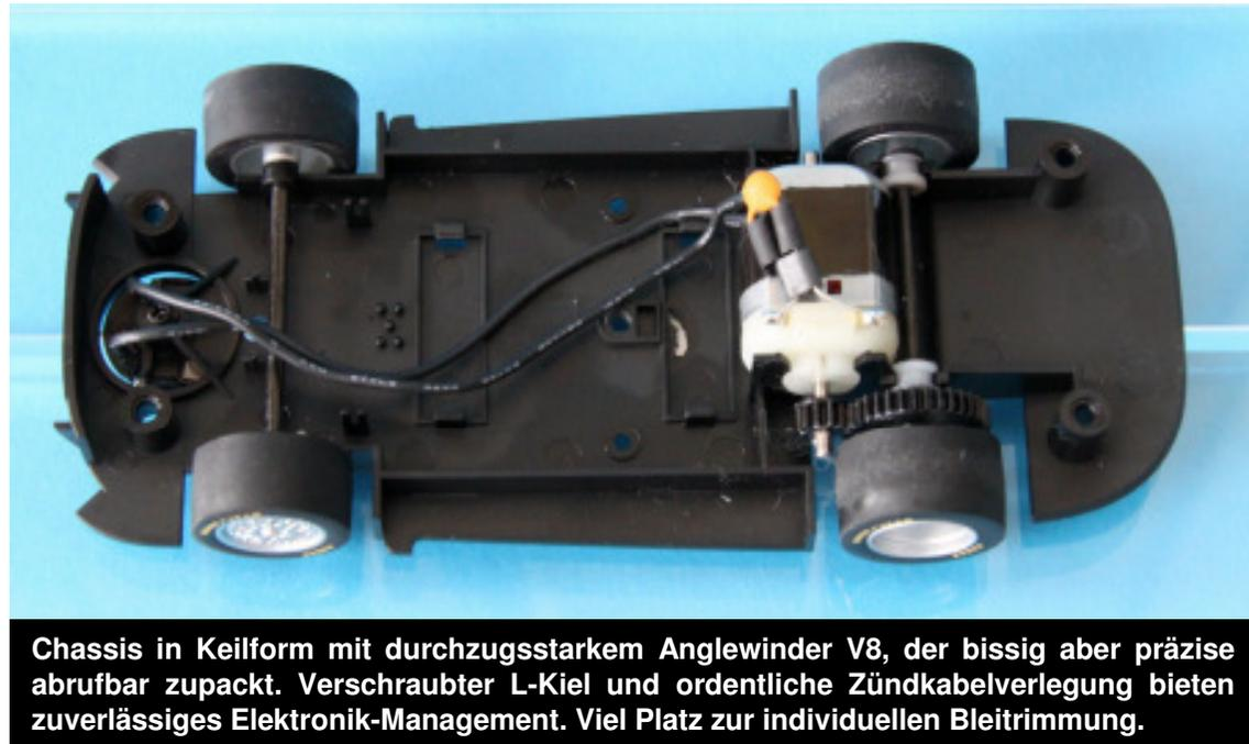
**Chassis in Keilform mit durchzugsstarkem Anglewinder V8, der bissig aber präzise abrufbar zupackt. Verschraubter L-Kiel und ordentliche Zündkabelverlegung bieten zuverlässiges Elektronik-Management. Viel Platz zur individuellen Bleitrimmung.**
