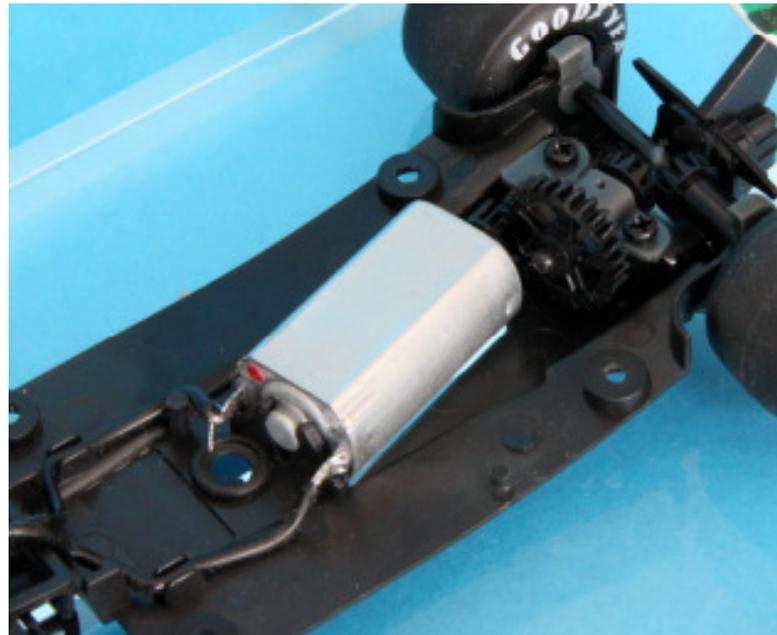
Neue Motoranordnung, völlig neues Getriebe. Wir taufen es vorgelagerter Angle-Inliner. Es überträgt die Kraft des vorgelagerten Motors über eine Welle über ein großes Zahnrad und ein Kleineres auf das Schneckengetriebe, das auf der Hinterachse sitzt. Der Schwerpunkt des Wagens sitzt sehr zentral und störende Höcker auf dem Karosserieheck sucht man vergeblich.
