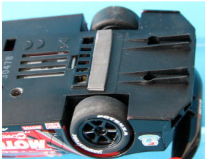
Wir haben die Reifen für mehr Grip auf ihren Felgen verklebt. Vorne Klarlack, drauf, hinten anschleifen. Noch eine Domstrebe Blei unter die Hinterachse und der Nissan liegt ohne MTS um Welten besser. Auch hier die L-Kielfeder raus und ein kleiner Ölservice. Fertig! Steckverbinder und LEDs wie am SLR...
