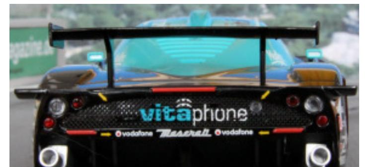
Kiemen saugen Frischluft ins Heck. Die Abwärme des Aggregats zirkuliert durch diesen Sog über das Lüftungsgitter nach außen. Der Flügel integriert sich FIA regelkonform in die Karosseriebreite ein.
