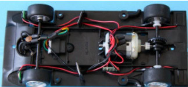
Inliner im breiten und tiefen Chassis. Der rote Kabelbaum versorgt die gute Lichtanlage.
