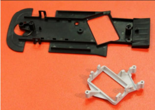
*Für 2010 gibts Rennsportchassis mit separatem Motorhalter! Die dreibeinige Aufhängung kann über Schrauben vom Hauptchassis entkoppelt werden, was die Fahrleistungen nach oben schrauben wird. Erhältlich für Ford GT, Renault Megane Trophy, Lamborghini Murcielago und Gallardo sowie für den neuen Audi R8!*
