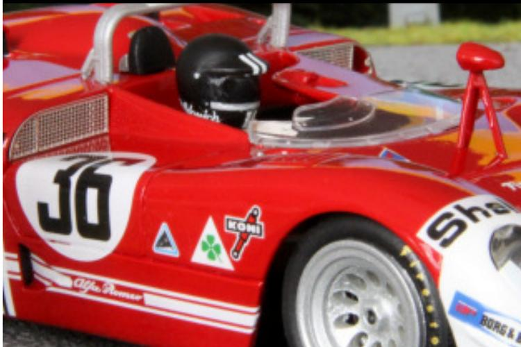
Zwei Frontflaps und senkrecht stehende Heckflossen stabilisieren das Alfa Heck bei Vollgas. Alufelgen mit breiten Firestones lassen schon ab kalter Betriebstemperatur die Strecke glühen. Das Setup der Bodengruppe liefert dem seigfähigen Italiener eine satte Straßenlage.
