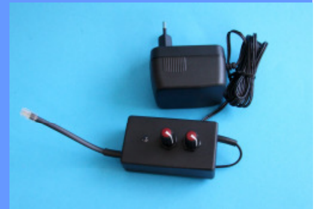
Ghostcar Modul GM V3 mit einstellbarer Geschwindigkeit plus Spurwechsoption, die durch eine separat einstellbare Zeitintervalleinstellung (zweiter Drehregler) ergänzt werden kann.
