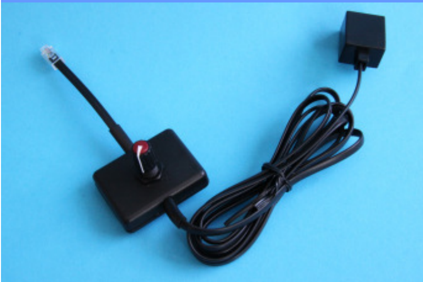
Der Speedlimiter kommt zwischen Anschlussbox und digitalen Regler und drosselt stufenlos die Geschwindigkeit des Autos.
