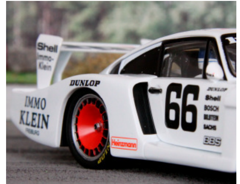
Massives Flügelwerk, breite Kotflügel und Aerodynamik-Rotor-Abdeckungen an den BBS-Speichenfelgen: Rennsport der 80er.
