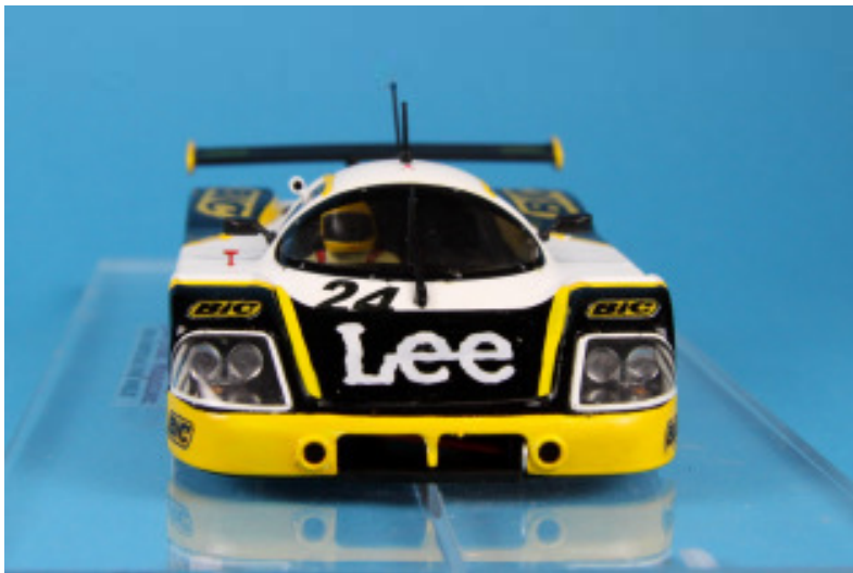
Slot.it Sauber C9: Mattweiß Revell mit Airgun aufgetragen, Gelb und Schwarz von Tamiya Acryl von Hand gepinselt.
