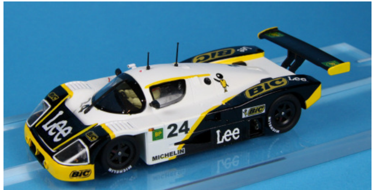
Slot.it Sauber C9: Mattweiß Revell mit Airgun aufgetragen, Gelb und Schwarz von Tamiya Acryl von Hand gepinselt.
