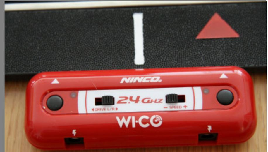
Störungsfreie 2,4 GHz Funktechnik, zwei Geschwindigkeiten und ein Richtungsschalter. Programmierknöpfe kinderleicht bedienbar.
