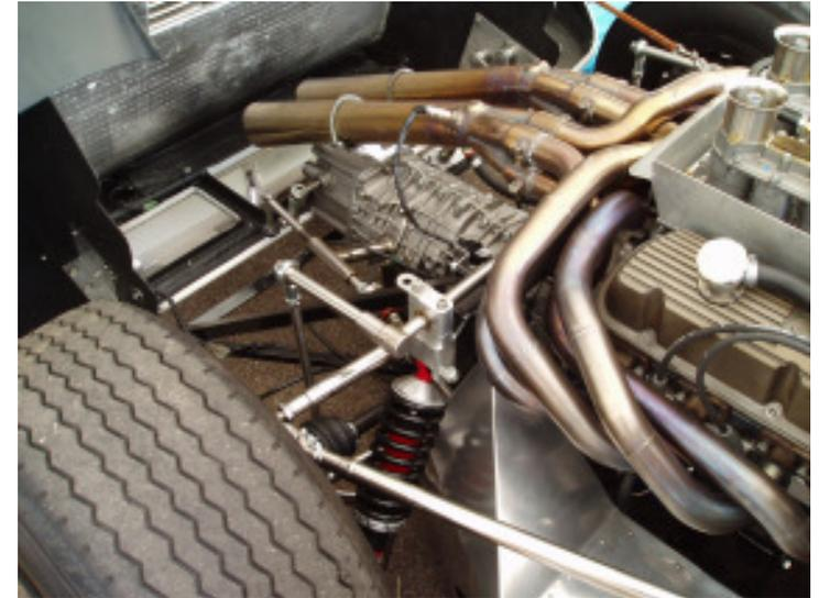
**Die doppelläufige Auspuffanlage im Detail. Darunter sitzt das synchronisierte Fünfgang ZF Getriebe**
