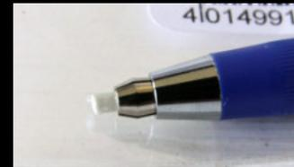
**Glasradierer:** entfernt Ablagerungen u.a. an den Schleifern. Einfach abbürsten und weiter geht es mit deutlich mehr Leistung.
