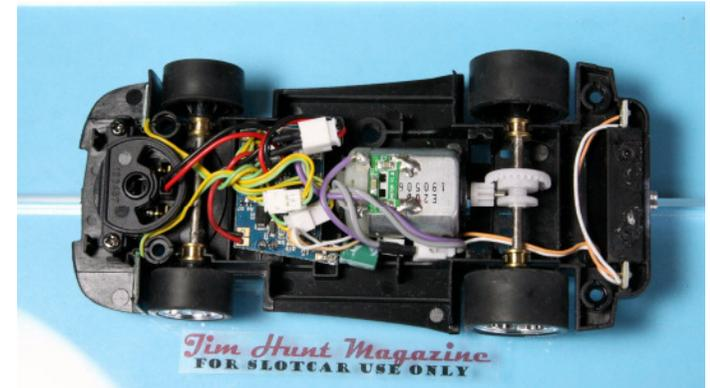
**Inliner Antrieb, vier Messingradlager, ein solider L-Kiel mit langem Schwert und viel Kabelbaum wegen der digitalen Platine. Der 935 K3 ist solide konstruiert und fährt sich in allen Situationen top!**
