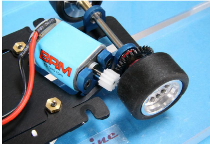
Links: präzise Einzelradaufhängung und schön gelöste L-Kielsituation. Die beiden Zündkabel verlaufen aufgeräumt durch das Chassis von vorne nach hinten zum Motor.
