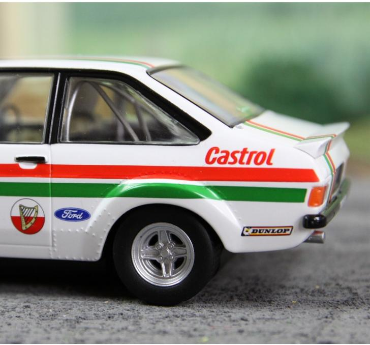
Weit ausgestellte Radhäuser gegenüber der Serie und Ford Motorsport Felgen darunter. Das Heck schließt eine dynamische Spoilerlippe auf dem Kofferraum Deckel ab. Sie liefert der Hinterachse mehr Anpressdruck. Hinterachse mit Differential stammen vom 3 Liter Capri und können den brutalen Kräften des aggressiv hochdrehenden Vierzylinders sehr gut widerstehen.
