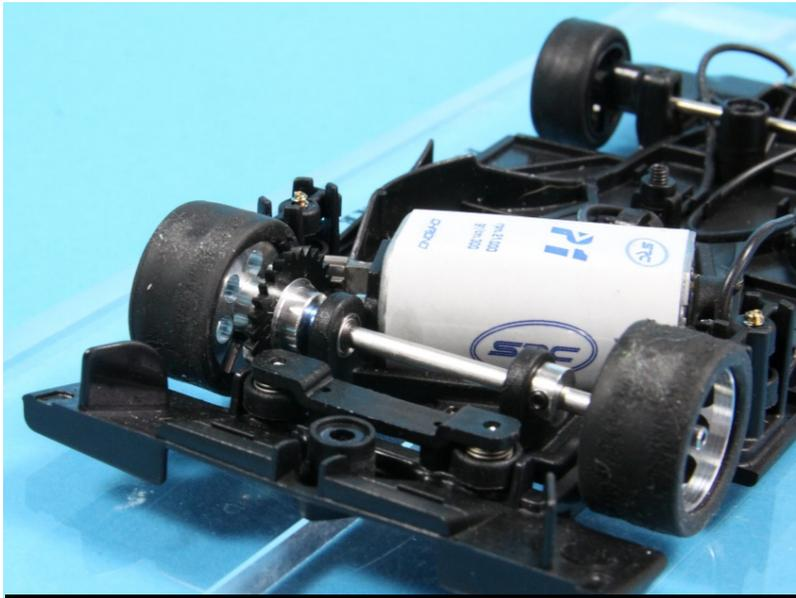
Hohl-Hinterachse mit Stellring und Kugellagern. 21000 Touren und 300 gcm Drehmoment beim Longcan P1.
