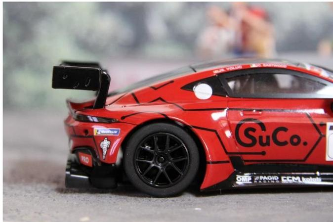
Verschiedene Flügel Aufhängungskonzepte: Bei Aston stützt ein doppelter Boomerang von vorne. AMG setzt auf eine doppelt geschwungene Fachwerkskonstruktion.
