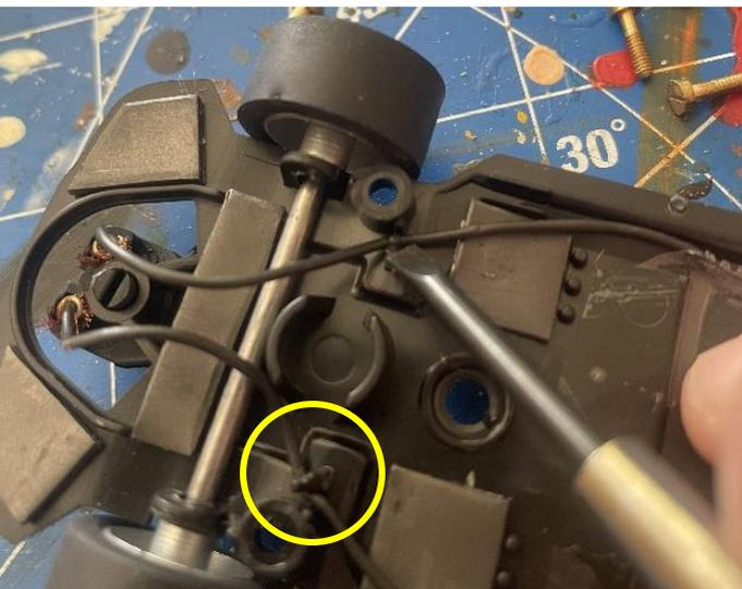
Seitlich an den Schrauböffnungen vorne gibt es je einen Zapfen, der ein Zündkabel hält. Werksseitig macht er das nicht so, wie es sein sollte: fest! Mit einem Schraubendreher jeden Zapfen in Richtung Bohrloch drücken/verbiegen. Durch Klemmung beider Kabel ist eine mittige Zentrierung des L-Kiels drin. Option: je 1 Tropfen Klebstoff.
