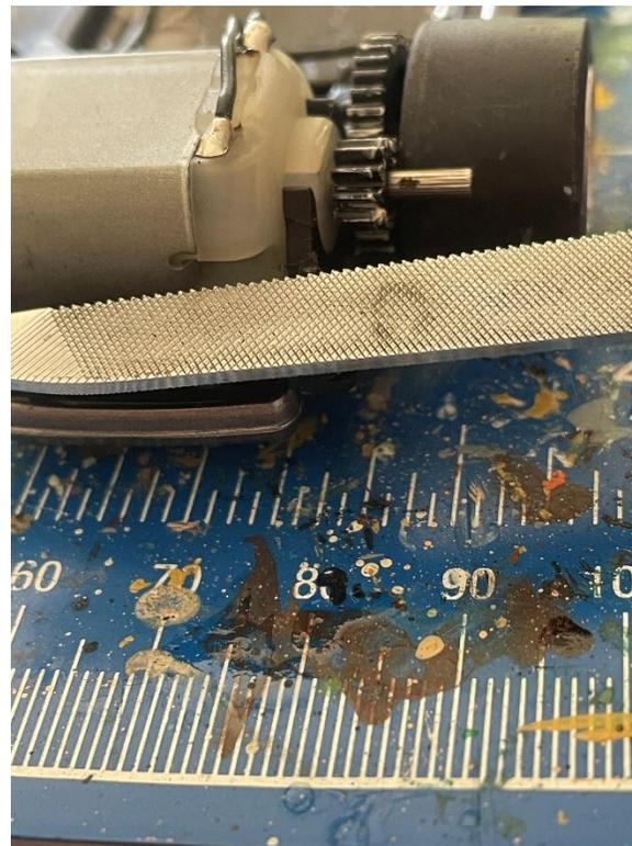
Eine Feile macht die Auflagen erst richtig flach. Darauf achten, dass sie möglichst waagrecht über das abzutragende Material geführt wird. Die Karosserie des Elfers kann sich darauf deutlich labiler bewegen als komplett fixiert in Serie. Das Tuning liefert ein spürbar besseres Fahrverhalten.
