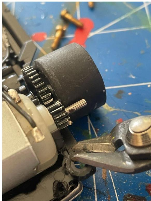
Seitlich um die Schrauböffnungen sind feine Stege angebracht. Sie fixieren die Karosseriesteher. Entfernt man die Stege, lässt sich sehr einfach mehr Spiel/Wackel der Karosserie auf dem Chassis herstellen. Ein kleiner Seitenschneider hilft. Messer ginge auch, dauert etwas länger.
