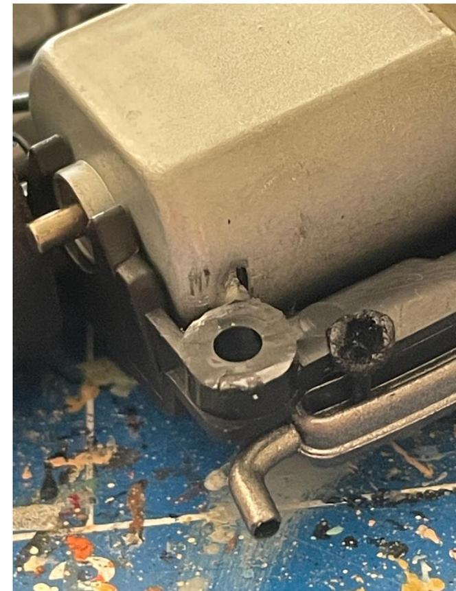
Wer mit original Schrauben weiter fährt, sollte die Löcher mit einer Feile dezent weiten. Wir nutzen metrische Schrauben, deren schlankere Präzision reicht, um dem Karosserie Aufbau genügend Spiel zu spendieren.
